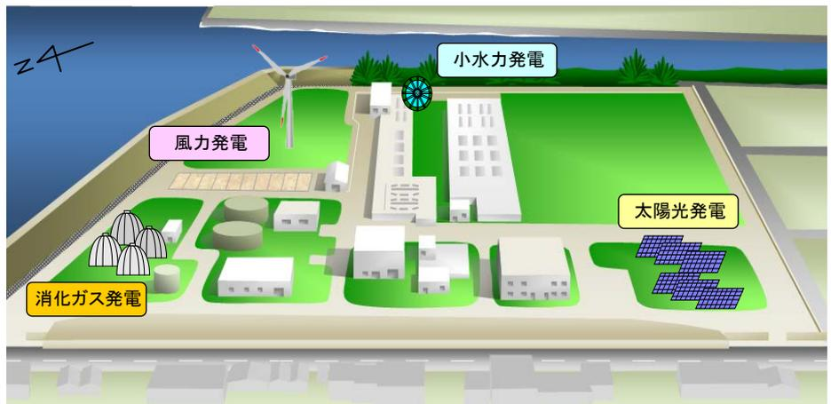
図-3 創エネルギー施設の設置概要図
